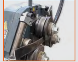
Köşebent Bükme Vals Topları ve Dayama Aparatı Angle Bending Rolls and Lateral Guide Rolls
